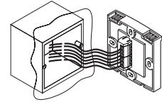
**Note :** Les bornes sont prévues pour recevoir des fils de section entre 0,32 et 2,1 mm<sup>2</sup>.
